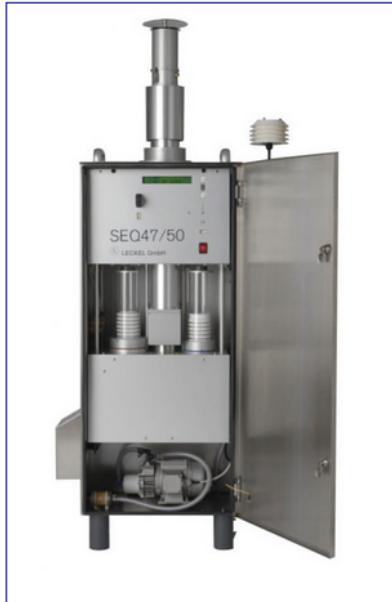
Figure 2-2 Préleveur séquentiel LECKEL
