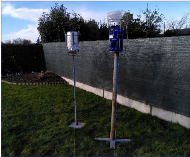
Figure 7-2 Photographie d'un prélèvement par Jauge Owen (P3)
